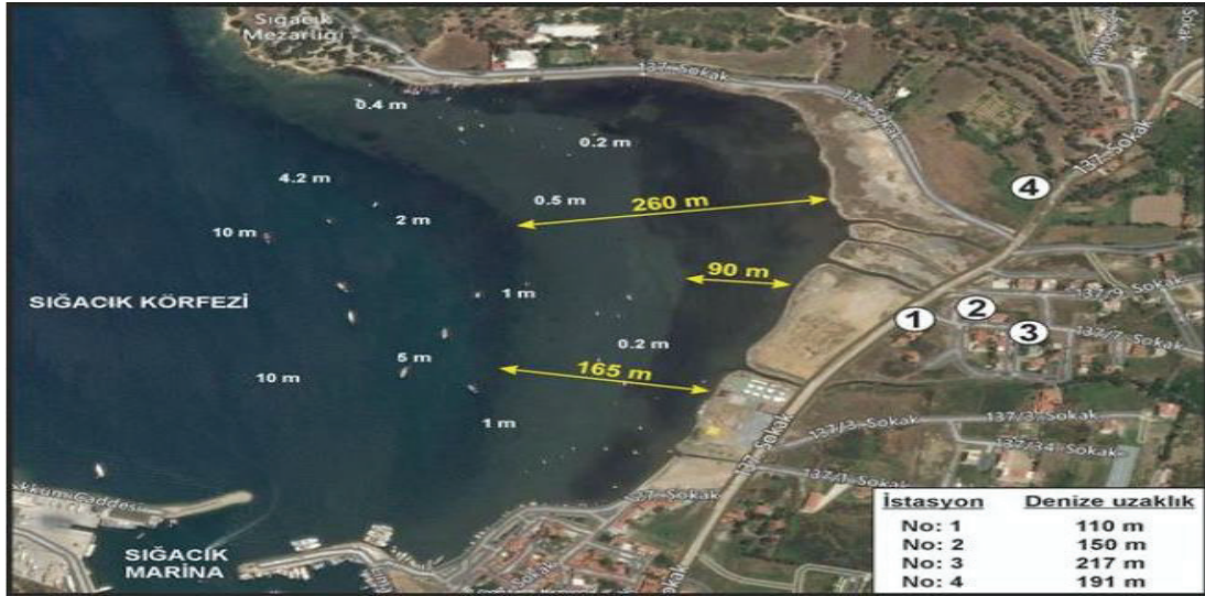
Şekil 2.9. Sığacık Körfezi'ne Ait Uydu Görüntüsü (Sarı renkli ok ve değerler deniz tabanındaki sığlaşan bölgeleri göstermekte iken beyaz renkli değerler yaklaşık deniz tabanı derinliklerini (C-Map&Navteq verisi) belirtmektedir) (DEÜ DAUM, 2020)
