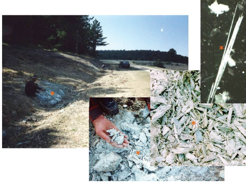
Resim 2.9. Yol Kenarından Aktoprak Çıkarılması, Çıkan Toprağın Gözle Görünür Lifsi Özelliği ve Elektron Mikroskopta Belirlenen Asbest Lifleri (Dr. M. METİNTAŞ)
