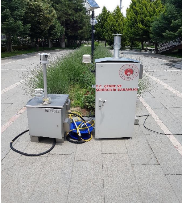
Şekil-1 Isparta Çevre ve Şehircilik İl Müdürlüğü Hizmet Binası Bahçesindeki Toz Örnekleme ve Uçucu Organik Kirletici Cihazları
