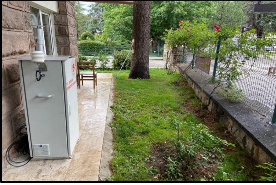
Şekil -3 Isparta Orman Bölge Müdürlüğü'ndeki Toz Örnekleme Cihazı
