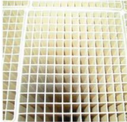
Şekil 39: SCR tekniği için kullanılan bireysel bir katalizör örneği [140, İtalya, 2007]
