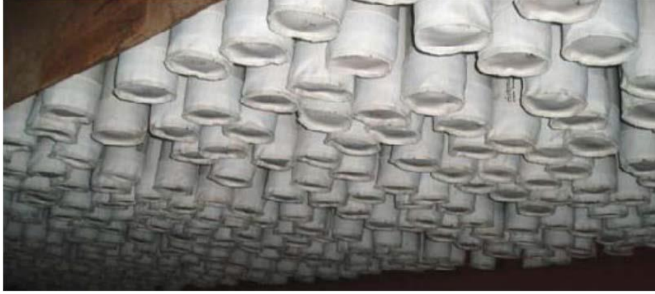
Şekil 36: İngiltere’de bir çimento fabrikasında kullanılan torba filtre ve filtre malzemesi örneği [82, CEMEX Rugby İngiltere, 2006]
