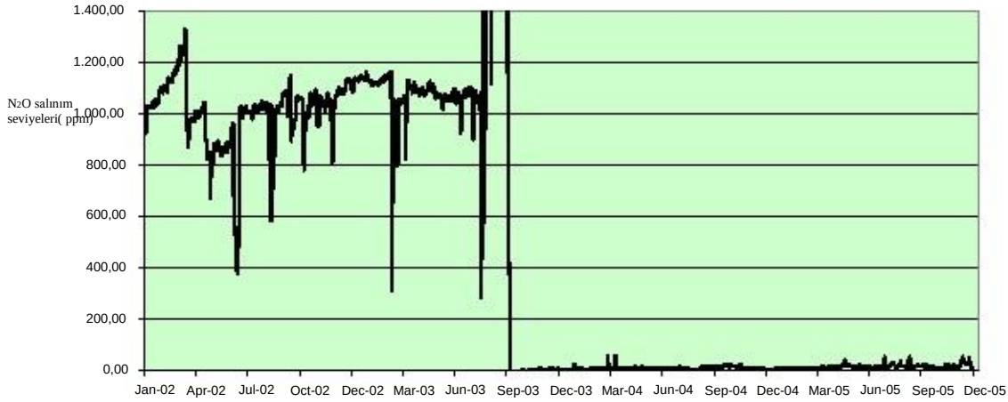
Resim 3.11: Kombine artık gaz iyileştirme işlemi öncesinde ve sonrasında N 2 O salınımları [100, AMI, 2006]
