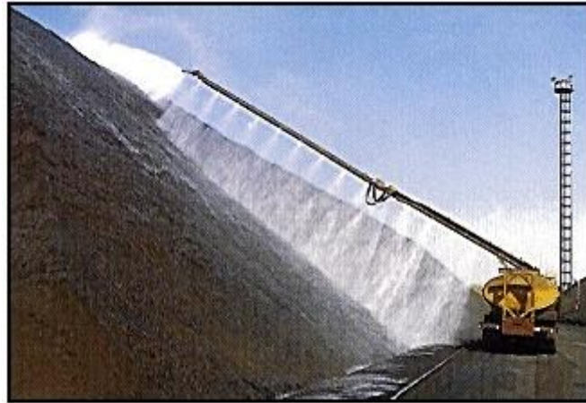
Şekil 4.20: İyi bir kabuk oluşturulması için tek tip püskürtme yapılması son derece önemlidir [134, Corus, 1995]
