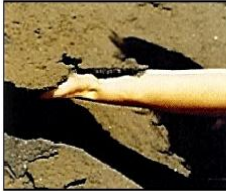
Şekil 4.19: Bir depolama yığınının yüzeyindeki kabuk oluşumu [134, Corus, 1995]
