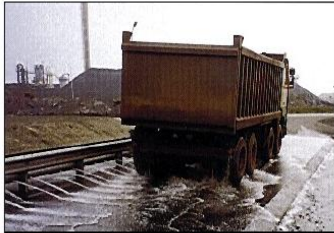
Şekil 4.32: Tekerleklerin döner yüzeyleri için hareketli su bulunduran birikinti [134, Corus, 1995]
