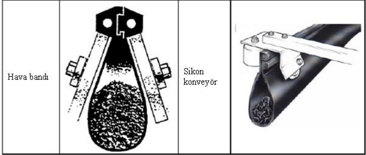
Şekil 3.44: Asılı kayış konveyörlere örnekler [78, DCMR Milieudienst Rijnmond, 1995]
