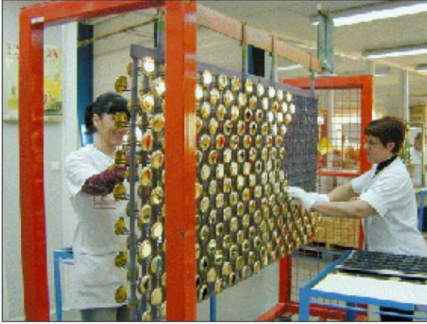
Şekil 2.5: Jig veya rack kaplama: cilalanmış bileşenlerin boşaltılması. Graingorge S.A., France ve Agence de l'eau Seine-Normandie.
