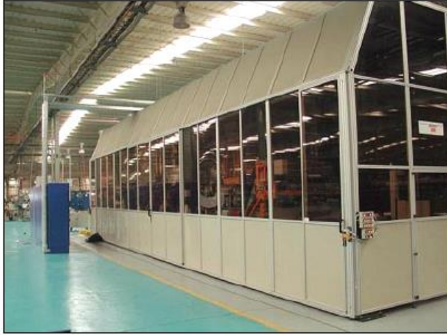
Şekil 4.2: Kapsüllenmiş entegre krom kaplama hattı [140, Atotech, 2003]
