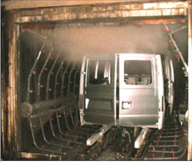
Şekil 2.4: Ana işlem öncesi fıskıye (sprey) işlemi gören otomotiv gövdesi [ACEA]
