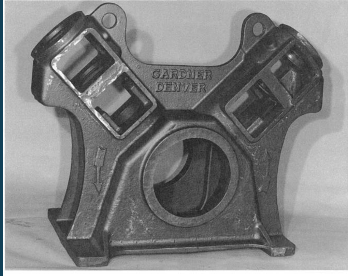
Bir hava kompresörü çerçevesine ait, 680 kg ağırlığındaki büyük bir kum döküm
