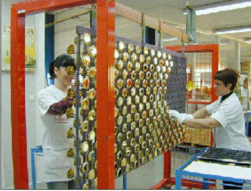
Şekil 2.5: Askı veya raf kaplama: parlatılmış bileşenlerin boşaltılması. Graingorge S.A., France ve Agence de l'eau Seine-Normandie.
