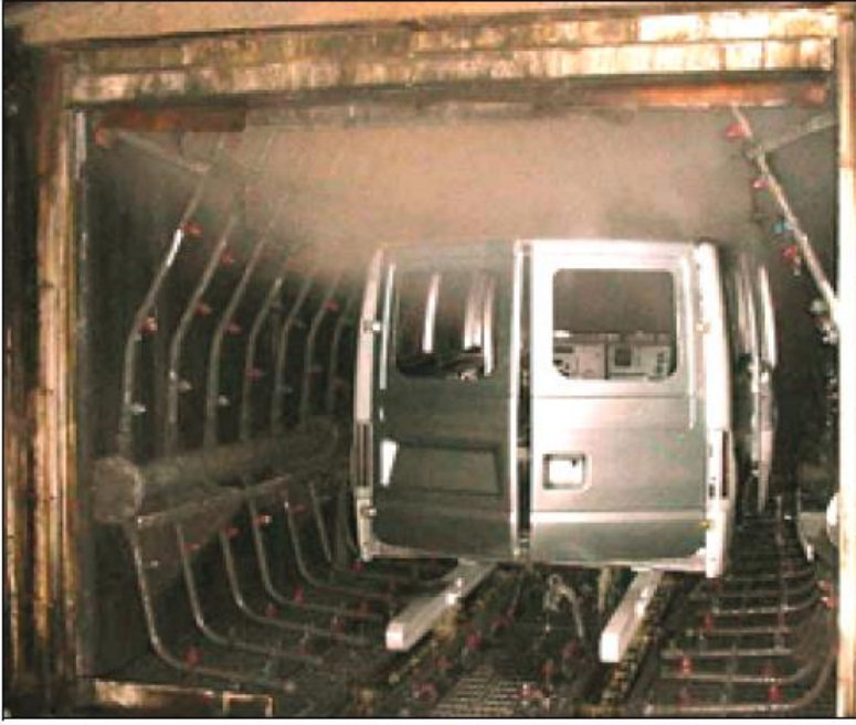
Şekil 2.4: Ana işlem öncesi fıskiye (sprey) işlemi gören otomotiv gövdesi [ACEA]
