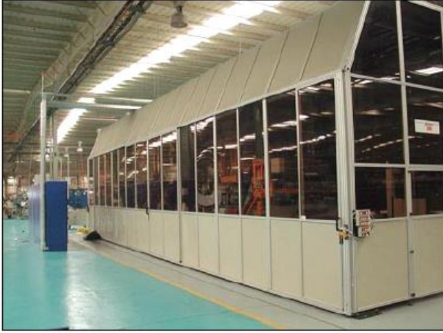
Şekil 4.2: Kapsüllenmiş entegre krom kaplama hattı [140, Atotech, 2003]
