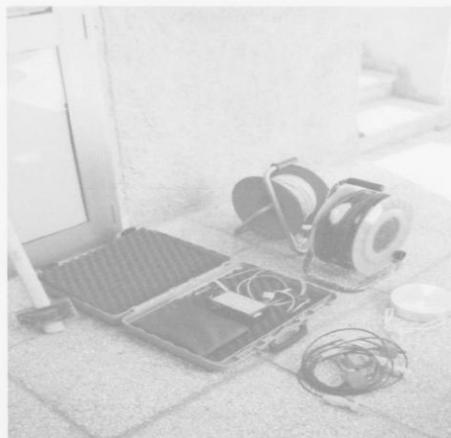
Bu projede, 2012 model SARA marka 12 kanallı DOREMİ model sismograf ve SARA marka 4.5 Hz'lık düşey bileşen jeofonlar kullanılmıştır.
