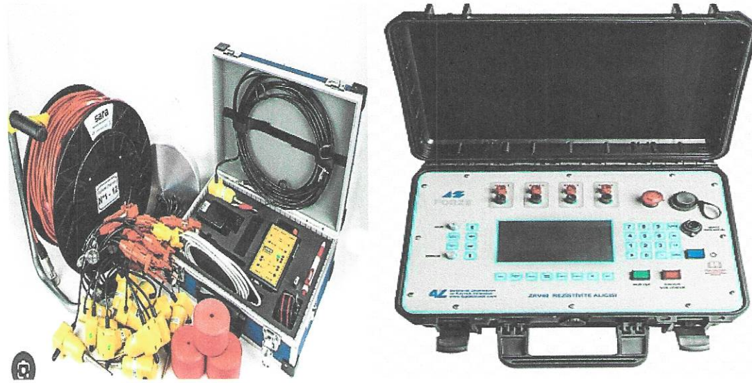
Şekil 8.2. Firmaya ait Sismik (a) ve Rezistivite (b) cihazlarının görüntüsü
