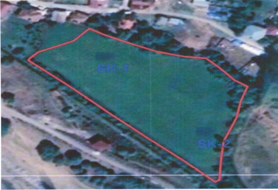
Şekil 8: Sondaj noktalarını gösteren uydu görüntüsü
