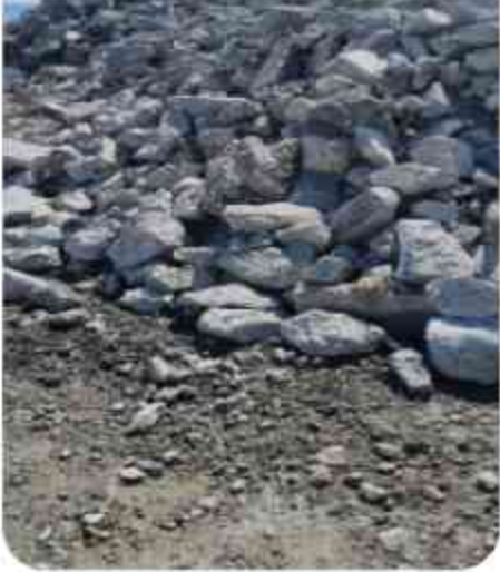
Girdi, örneđin kırılmıř beton
