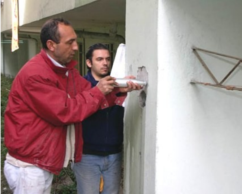
Schmidt darbe çekici ile yüzey sertliği değerinin okunması
