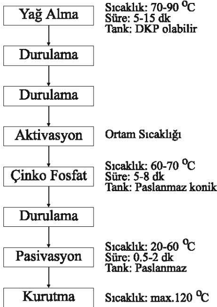
Şekil 3. Çinko Fosfat Prosesi Akım Şeması [12]
