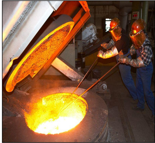
Resim 3.2 Elektrikli ocakta ergitme
