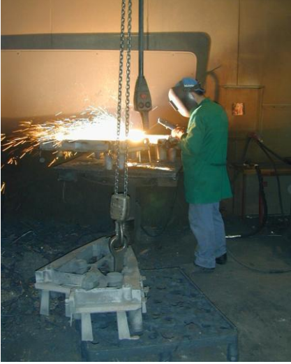
Resim 3.5: Döküm sonrası temizlik
