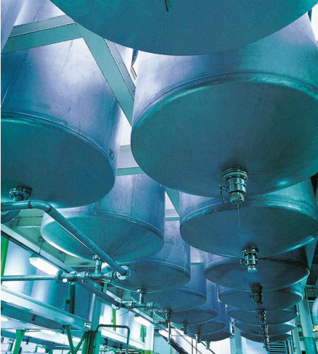
Resim 5.2: Cila üretimi – Konteyner boru sistemi
