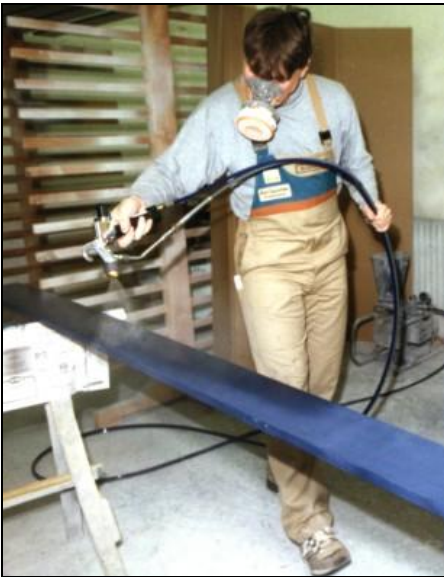
Resim 2.1: Bir Marangoz Atölyesinde püskürterek vernik /cilalama Fotoğraf: Wilfried Denz, www.denz-unweltberatung.de
