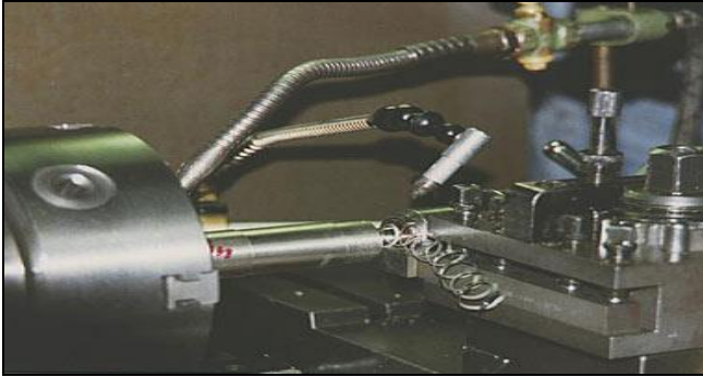
Resim.3.9: Minimum miktarda sürme uygulaması ile metal işleme Kaynak: HWK Mannheim; www.hwk-mannheim.de
