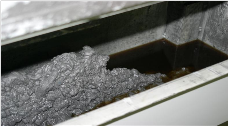
Resim 3.3: Taşlama çamuru ile kaybedilen yağ (Kaynak: Bosch San. ve Tic. A.Ş.)
