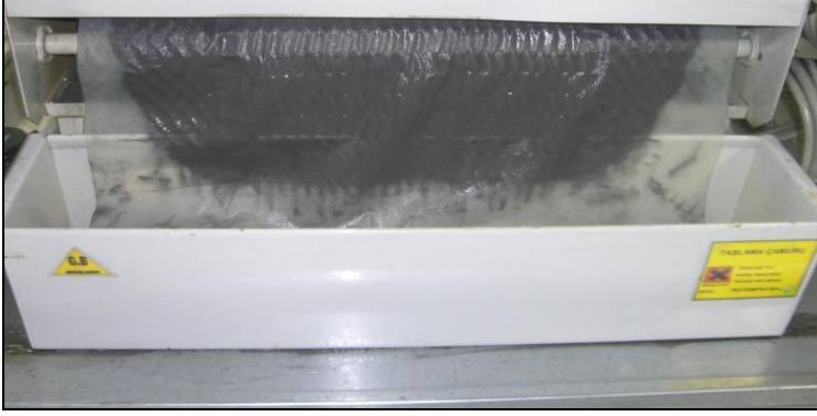
Resim 4.2: Tanktaki taşlama çamurunun alındığı kağıt filtre Kaynak: Bosch San. ve Tic. A.Ş.
