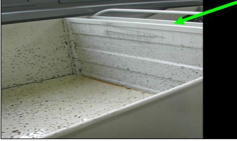
Resim 3.4: Talaş arabalarındaki delikli yüzeyler ile yağın alınması (Kaynak: Bosch San. ve Tic. A.Ş.)
