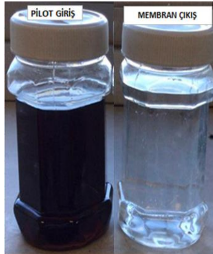
Şekil 22. Koyu lacivert rengine sahip atıksuyun pilot ölçekli tesiste arıtılması
