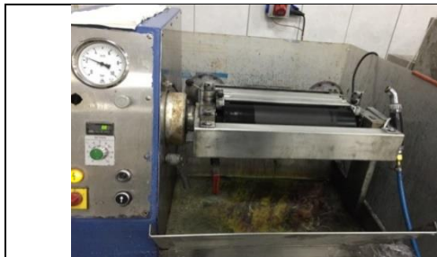
Şekil 27. Fulard boyama makinesinin çalışma prensibi
