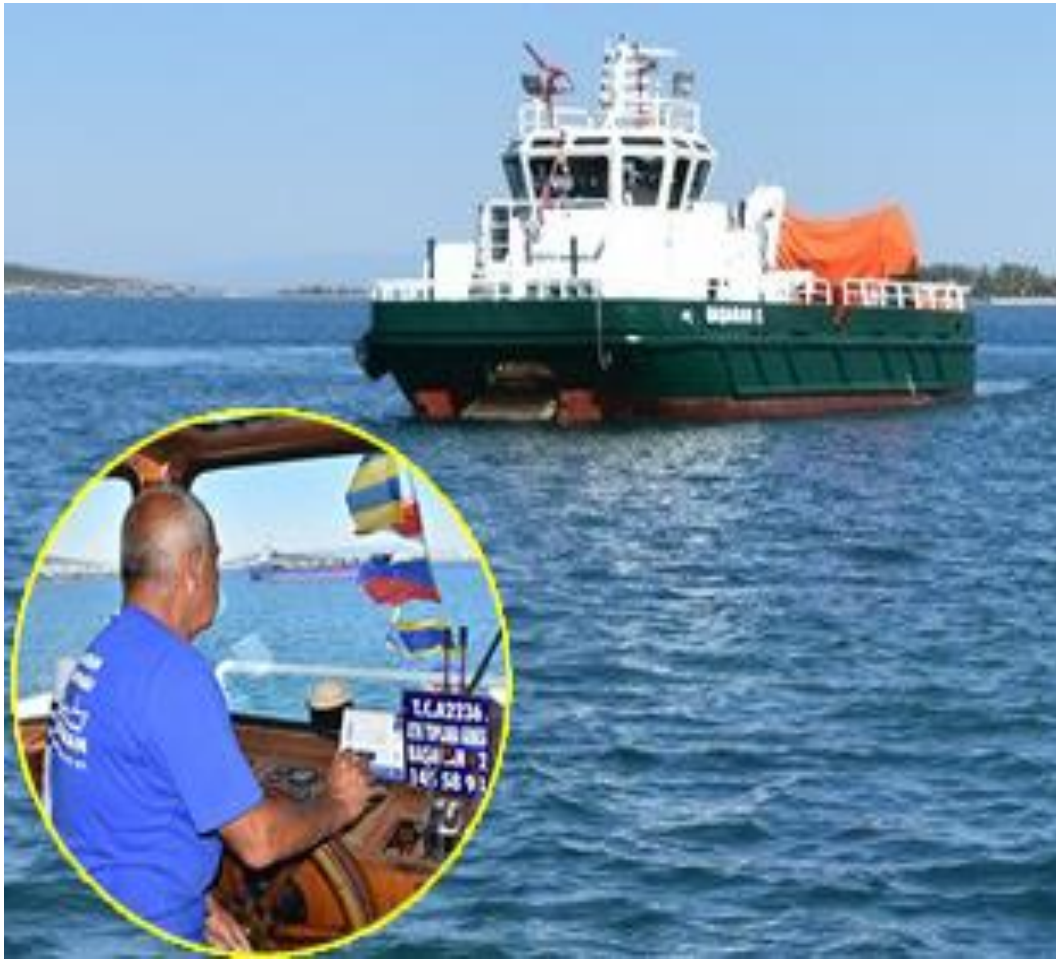
Şekil 30. Aliağa Belediyesi Deniz Yüzeyi Çöp Toplama Gemisi
