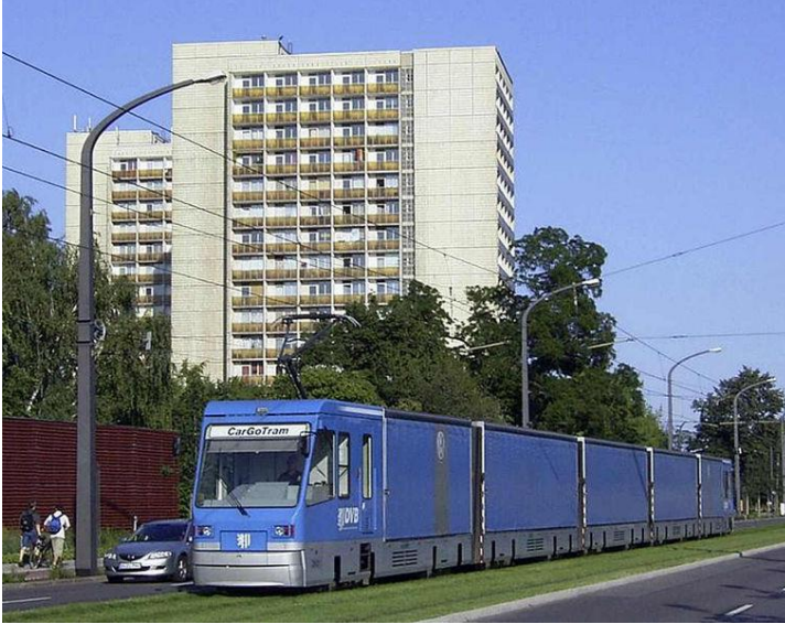
Resim 4 -21 : Bir yük tramvayı için Dresen’de çimenli ray
