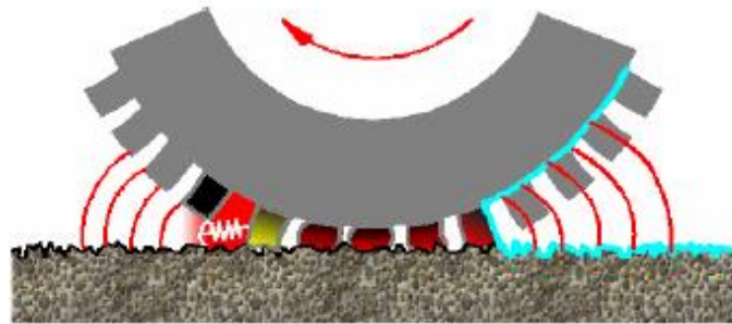
Resim B-17: Boru etkisinin şematik olarak gösterilmesi (Müller-BBM)
