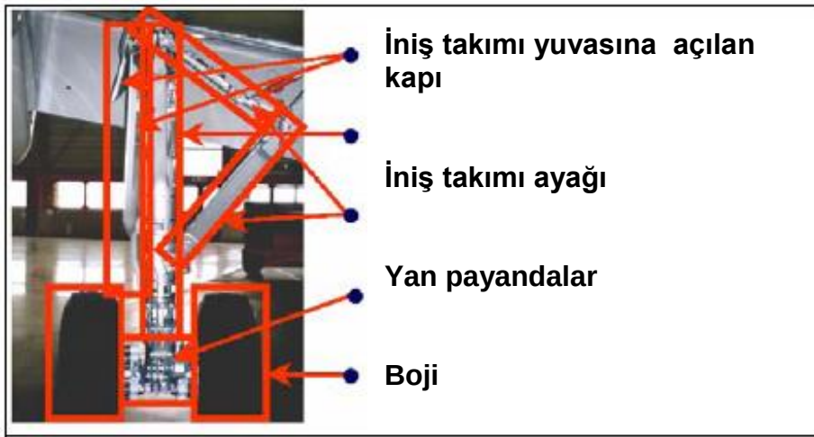
Resim 5-11: İniş takımlarındaki gürültü kaynakları [6]
