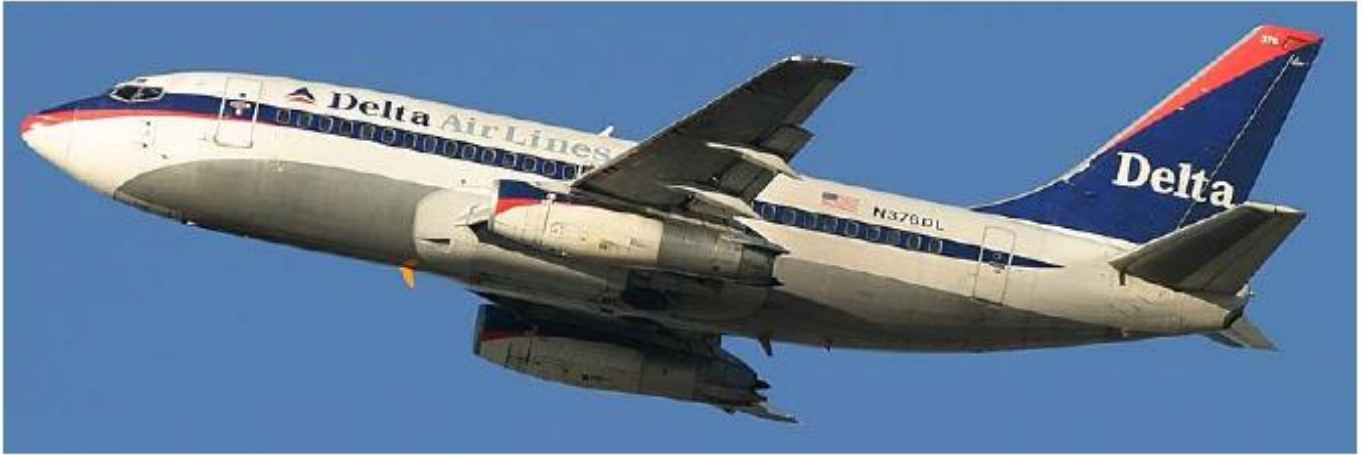
Şekil 5-27: Boeing B737 uçağında bir Hush-Kit [13]
