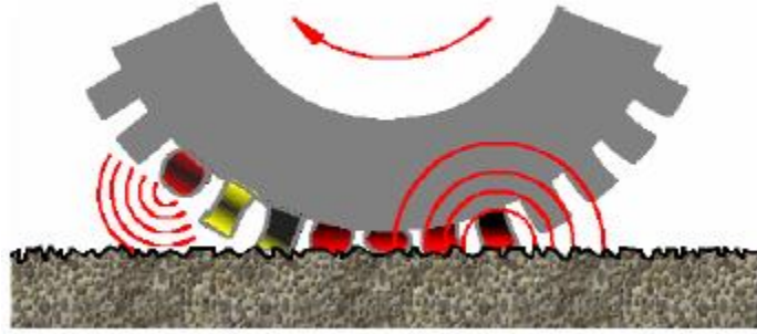
Resim B-2: Tekerleğin temas kısmından uyarılmasının şematik olarak gösterilmesi (Müller-BBM)
