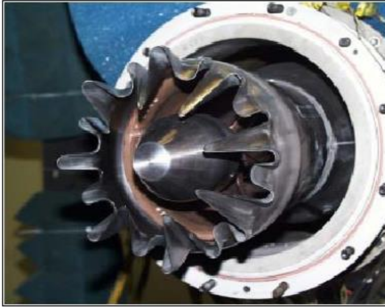
Şekil5-25: Bir jet motoruna sonradan takılan bir karıştırıcı [3]
