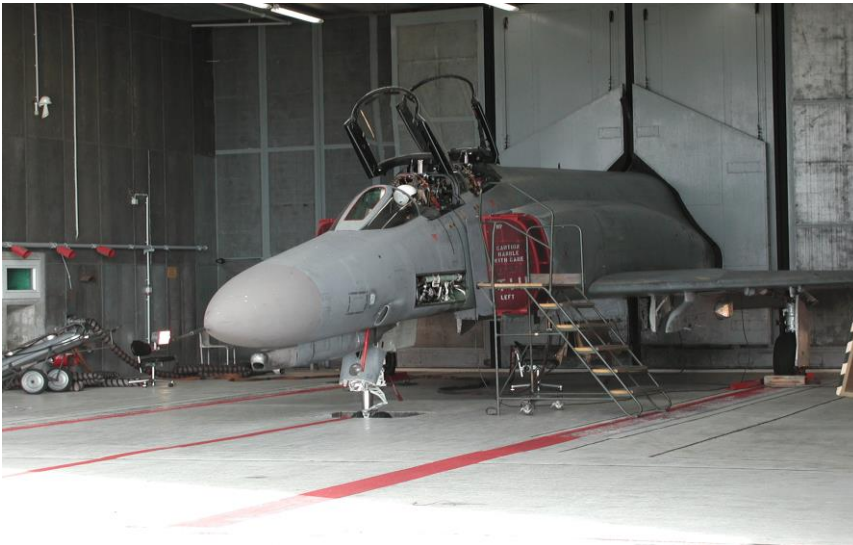
Resim 5-55: Alman Silahlı Kuvvetlerinin motor takımı test sürüşü için gürültü koruma ekipmanı
