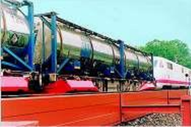
Resim 4 – 10: Raylara yakın mesafede alçak konumlandırılmış bir gürültü perdesi ile kombine edilmiş ve giydirilmiş boji çerçevesine sahip DB AG (Alman Demiryolları) anonim şirketine ait bir yük treni prototipi
