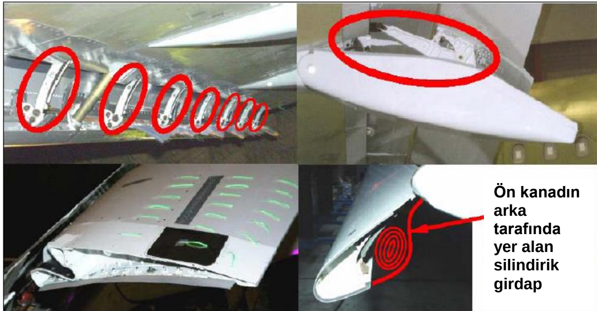
Resim 5-10: Taşıyıcı kanattaki aerodinamik gürültü kaynakları [6]
