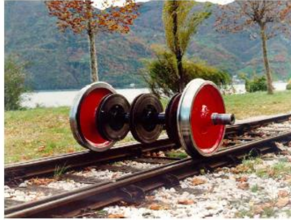
Resim 4 – 6: Tekerleğin kaplaması biçiminde bir tekerlek emici (Lucchini firmasına ait Ras Syope)
