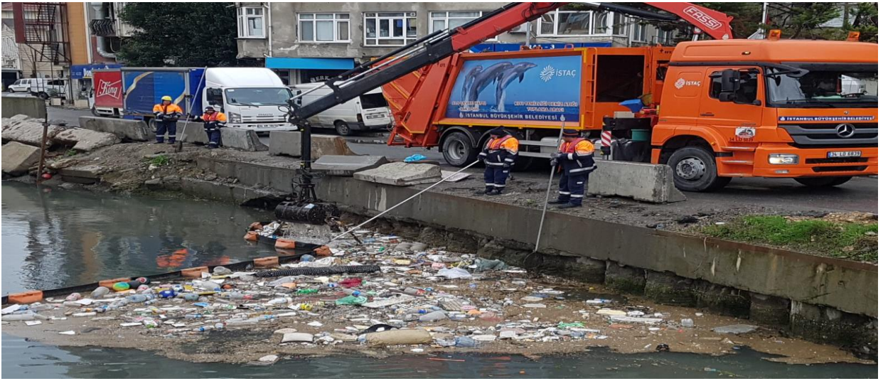
Şekil 36: Vinçli Atık Toplama Aracı İle Deniz Çöprü Toplama Çalışması (2)
