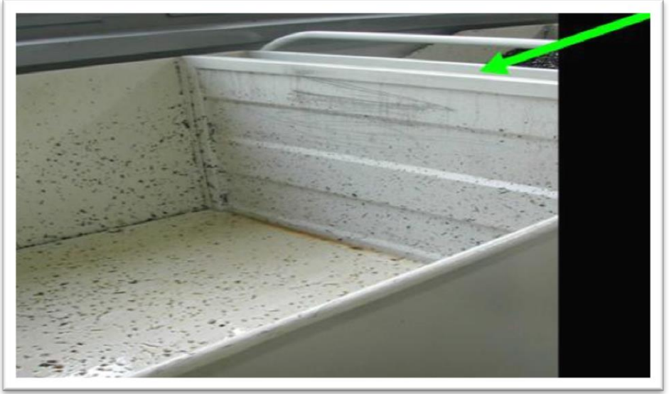
Resim 3.4: Talaş arabalarındaki delikli yüzeyler ile yağın alınması (Kaynak: Bosch San. ve Tic. A.Ş.)
