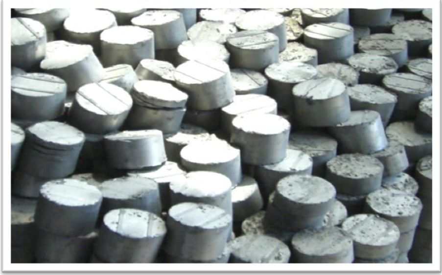
Resim 3.5: Briketlenerek yağı alınmış taşlama çamurları (Kaynak: Bosch San. ve Tic. A.Ş.)
