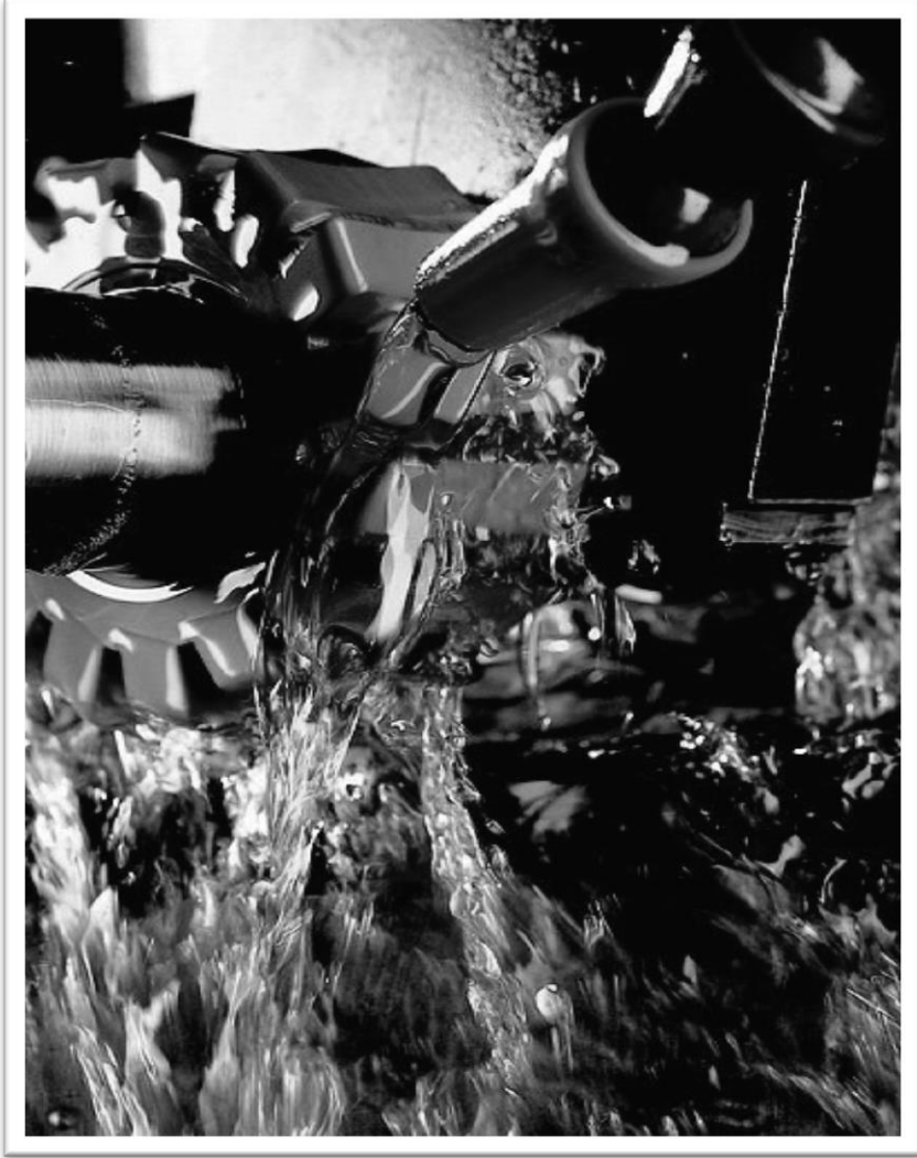
Resim 2.1: Kesme yağları ile dişli çark yapımı Kaynak: Fuchs Petrolub AG
