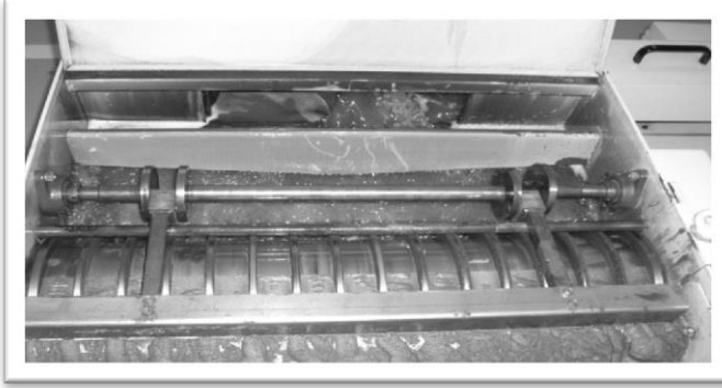
Resim 4.1: Tanktaki taşlama çamurunun mıknatıslı ayırıcı ile alınması
