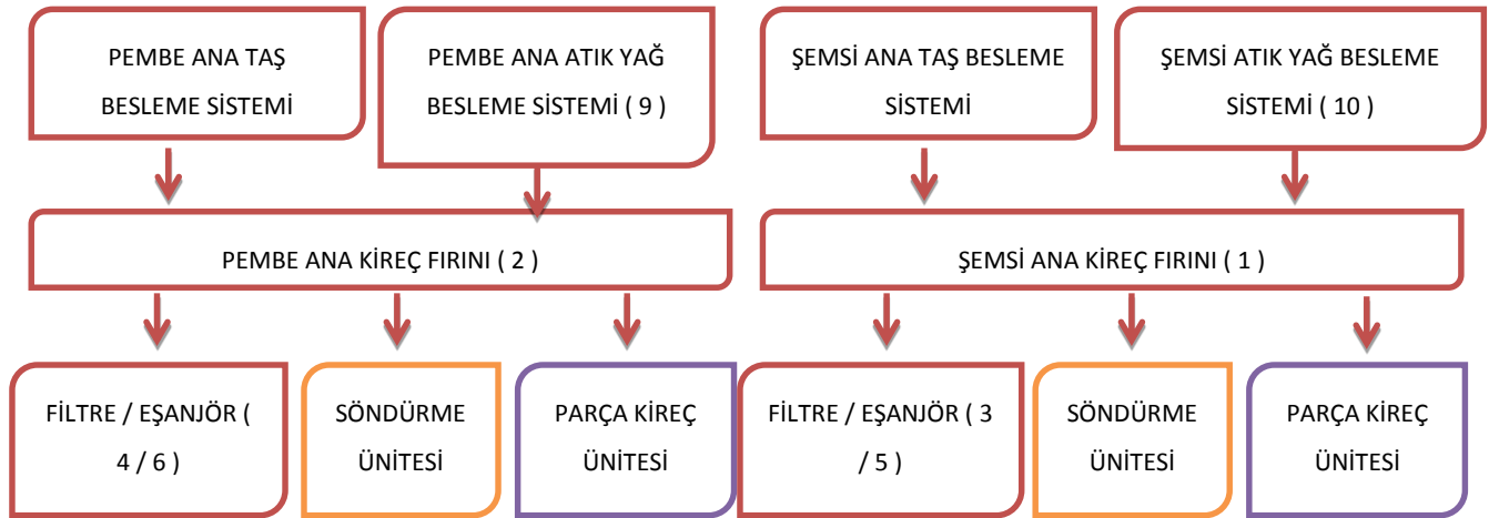
Şekil 11.103: Fırınlar Ünitesi Akım Şeması
