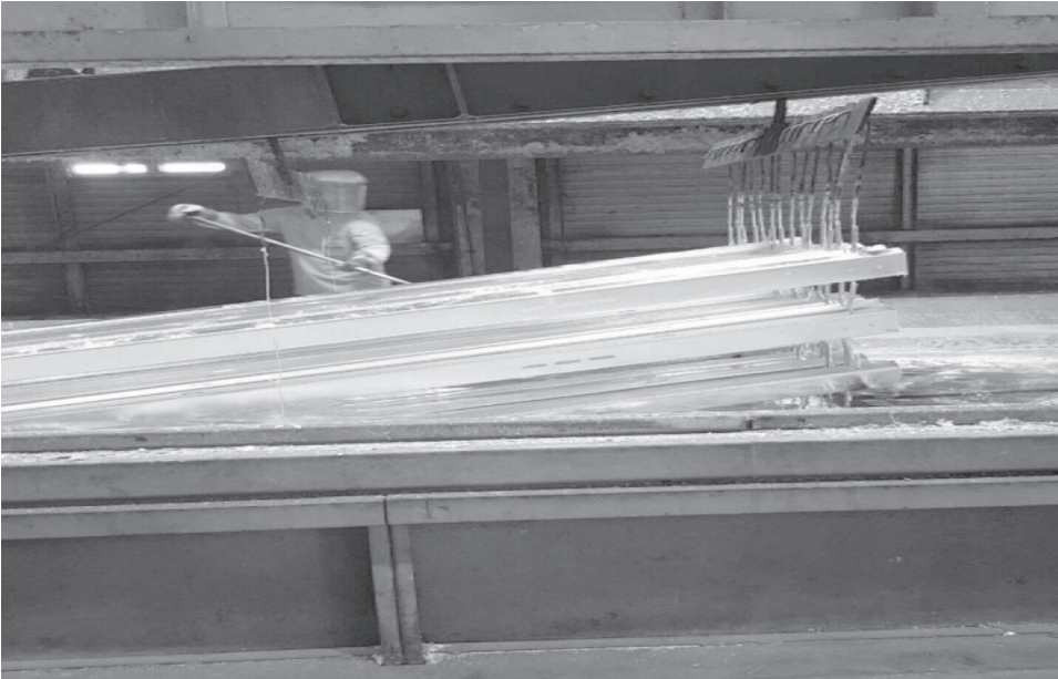
Şekil 2. Sıcak daldırma galvaniz kaplama banyosu
