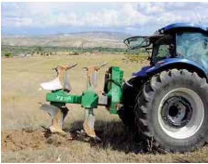
Fotoğraf 5-8 Riperle Toprak İşleme (Lastik Tekerlekli)
