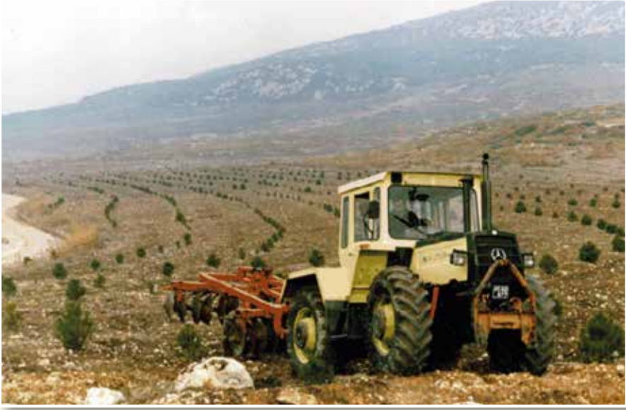
Fotoğraf 5-45 Lastik tekerlekli traktör diskoro ile bakım
