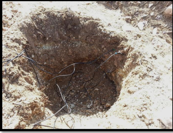
Şekil . Bir toprak işleme türü üzerinde üç farklı derinlikte toprak nem sensörlerinin yerleştirilmesi
