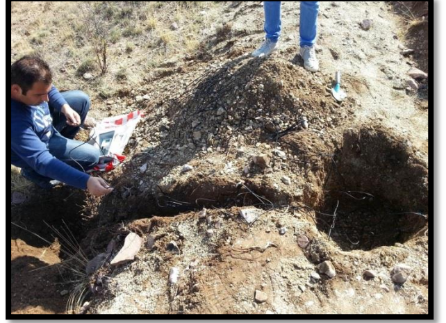
Şekil . Bir toprak işleme türü üzerinde üç farklı derinlikte toprak nem sensörlerinin yerleştirilmesi
