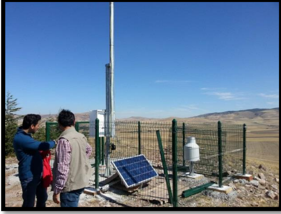
Fotoğraf: . Proje alanı otomatik meteoroloji stasyonu krulum çalışması
