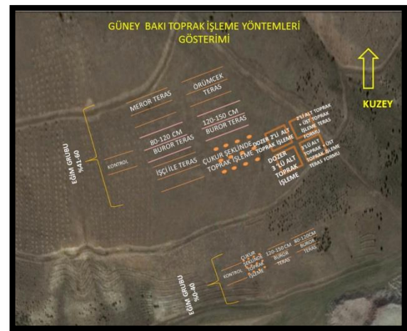
Şekil . Kuzey ve Güney baki farklı eğimlerde toprak işleme deneme deseni
