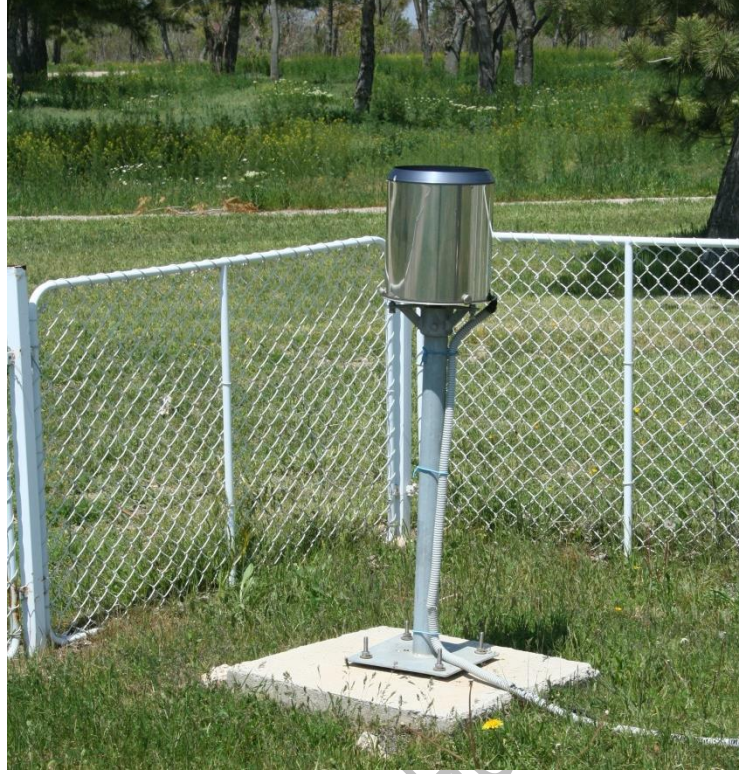
Şekil X: Bir konvansiyonel klimatoloji ve meteoroloji ya da otomatik hava gözlem istasyonunda yağış gözlemi yapılmasında kullanılan bir plüviografın (yazıcısı olan yağışölçer) görünüşü (Foto: Murat Türkeş, 26 Nisan 2013, GTHB Bahri Dağdaş Uluslararası Tarımsal Araştırma Enstitüsü OHGİ parkı).
