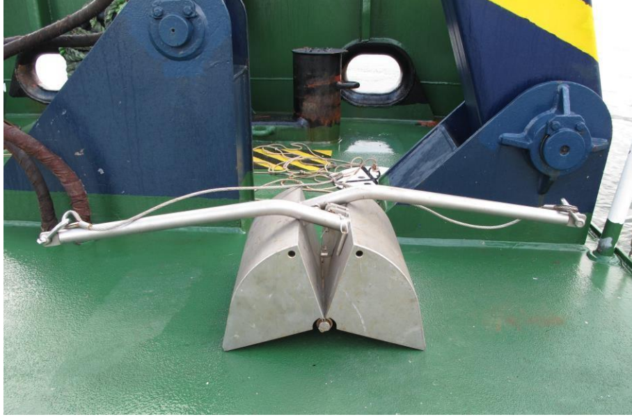
Şekil 2 R/V TÜBİTAK Marmara Araştırma Gemisi'nde kullanılan 35 kg ağırlığındaki Van Veen Grab
