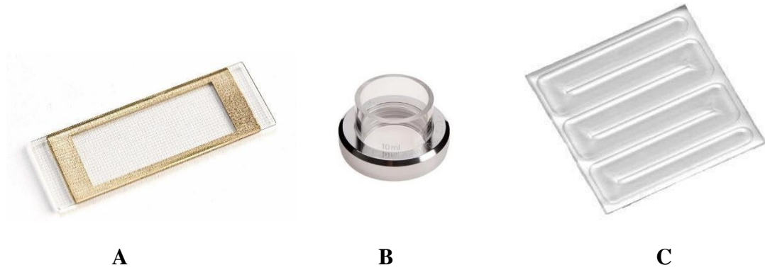
Şekil 6. Plankton sayım kamaralarına örnekler: A. Sedgewick-Rafter, B. Utermöhl sedimantasyon kamarası, C. Zooplankton sayım kamarası.
