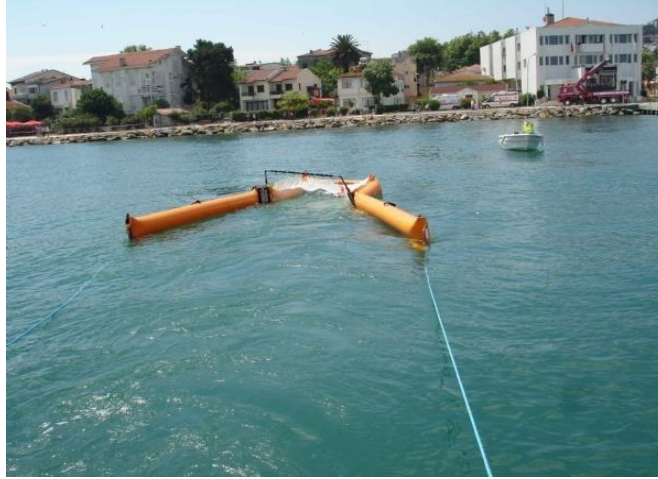
Şekil 3. Waste Free Oceans kapsamında dizayn edilen ve deniz yüzeyindeki atıkların toplanması için kul anılan özel ağ.
