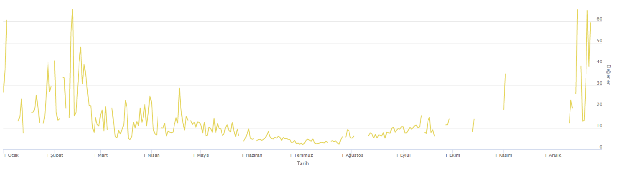
Grafik A.37- 2022 yılında Turgutlu istasyonu NO parametresi günlük ortalama değer grafiği (sim.csb.gov.tr, 2023)
