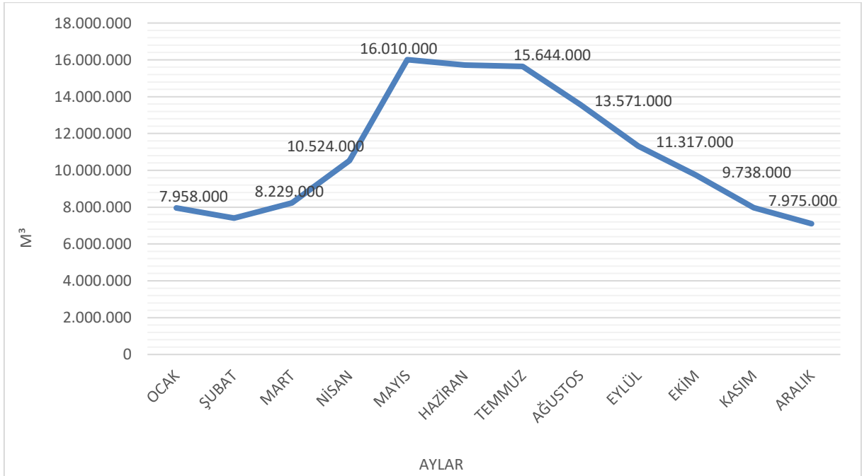
Grafik C.24 - Konya ilinde 2022 Yılı Altınapa Baraj Gölü Su Miktarının Aylara Göre Değişimi (KOSKİ, 2022)
