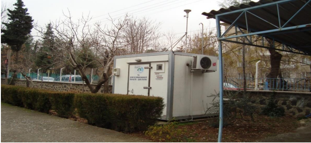
Resim A.1 - Gaziantep Hava Kalitesi Ölçüm İstasyonu
