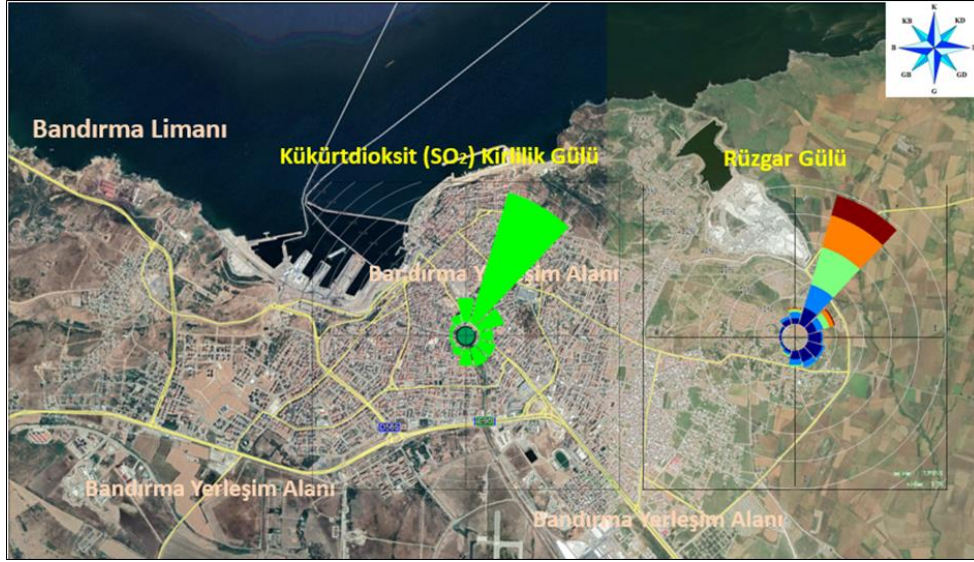
Harita A.8 - Bandırma Hava Kalitesi İzleme İstasyonu 2020 Yılı Kükürtdioksit (SO 2 ) Kirlilik Gülü
