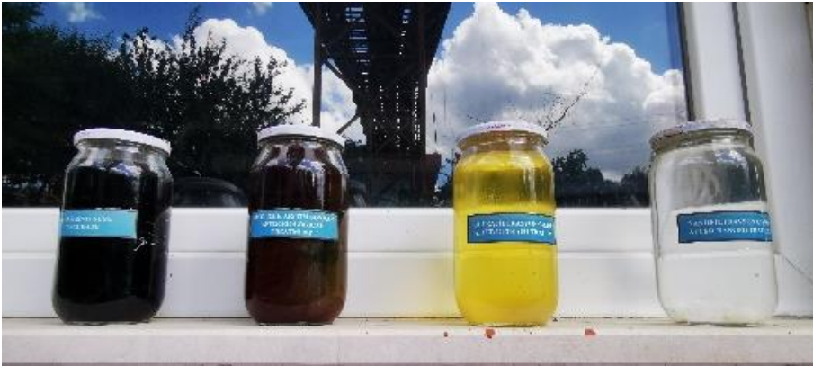
Resim C.4 Sızıntı Suyu ve Çıkış Suyu
