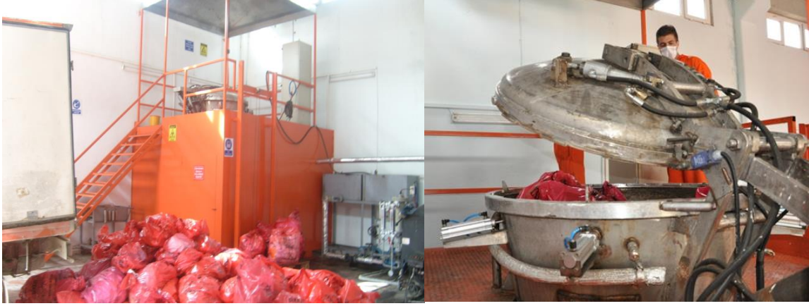
Şekil C.19- Tıbbi Atık Sterilizasyon Tesisi
