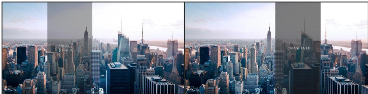
Şekil 3. Amorf silikon solar camın yüksek (solda) ve orta şeffaflık değerlerinde ışık geçirgenliği.
