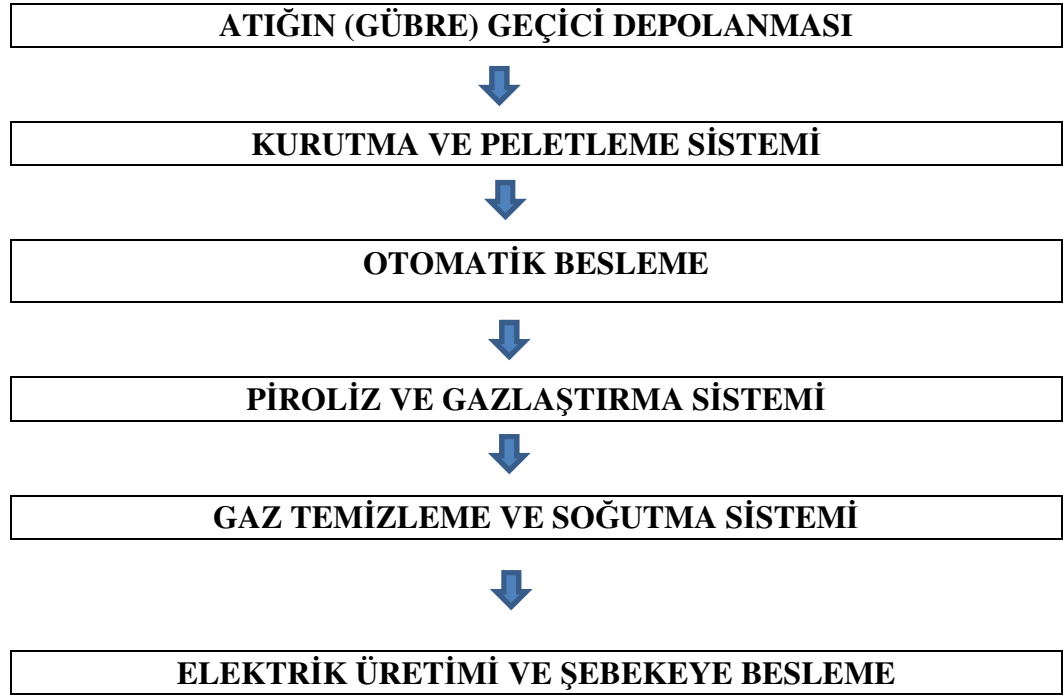
Şekil 3. Piroliz, Gazlaştırma ve Enerji Üretimi Genel İş Akım Şeması
