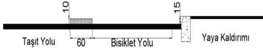
Şekil 7 - Taşıt yolundaki bisiklet yolunun refüjle ayrılması
