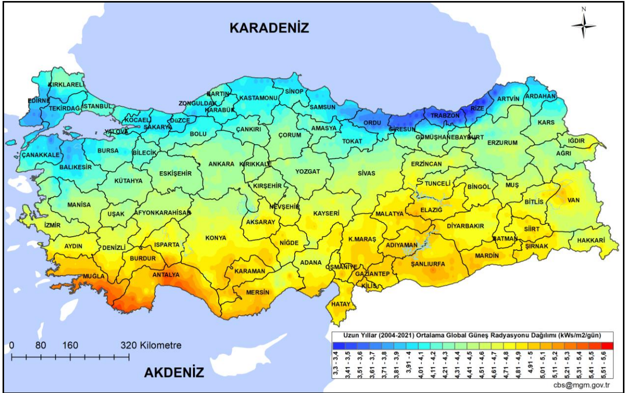
Şekil 1. Türkiye 2004-2021 Ortalama Global Güneş Radyasyonu (Enerjisi) Dağılımı (kW/m²/gün)
