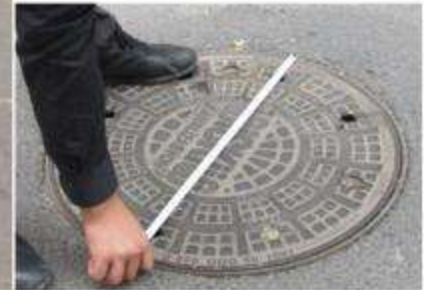
Şekil 31: Sahada ve earthmine da yapılan kenar ölçmeleri
