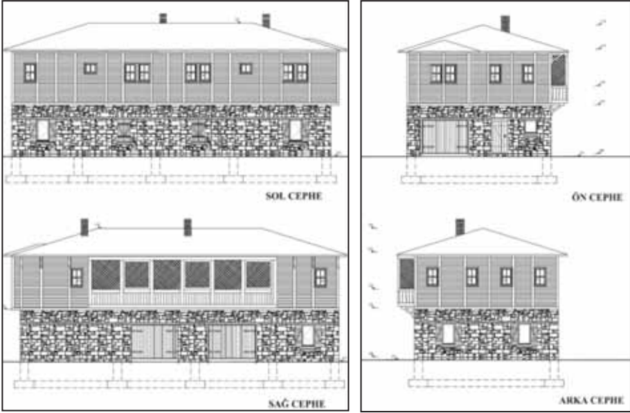
Balıkesir Kırsalında Yapı Cepheleri
