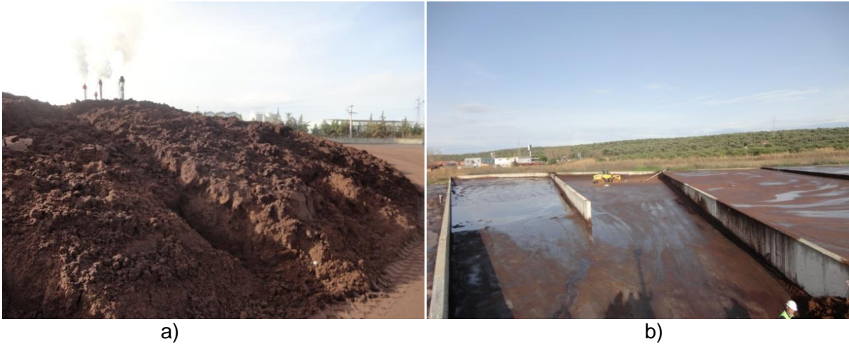
Şekil 33 Pirinanın depolaması a) 3 fazlı üretim prosesinden oluşan pirina b) 2 fazlı üretim prosesinde oluşan pirina
