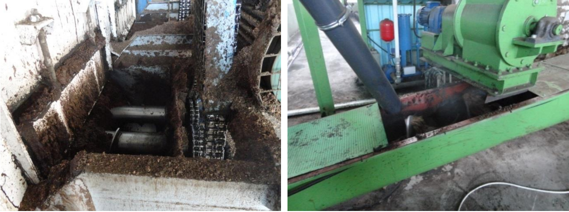
Şekil 35 Kurutulmuş 3 fazlı pirina ile sulu 2 fazlı pirinanın karıştırılması
