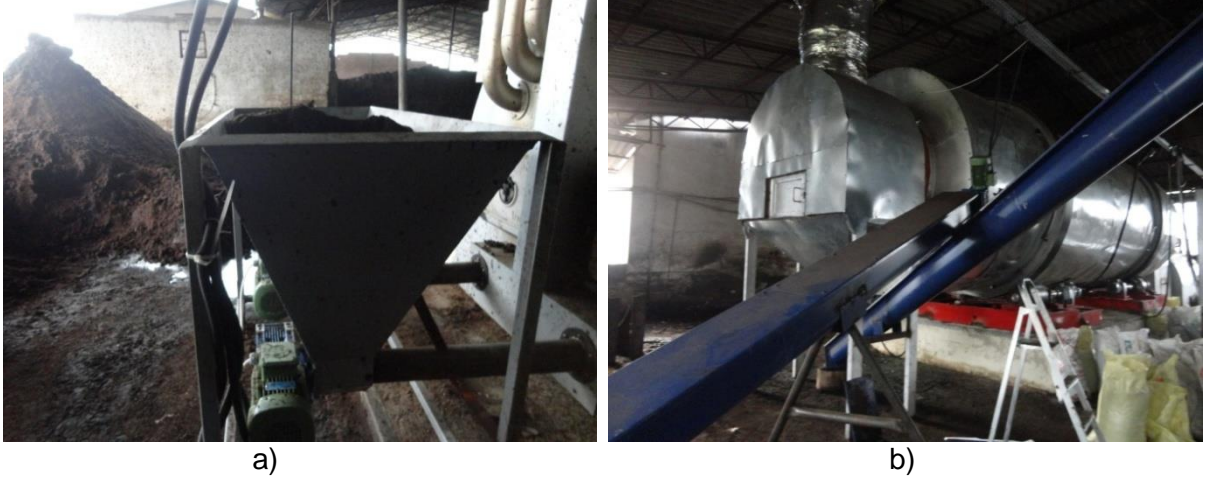
Şekil 34 Yağcı Gıda tarafından Doğan Zeytinyağı Fabrikası'na kurulan sistem a) Zeytin çekirdeği ayırma makinası b) Kurutma sistemi
