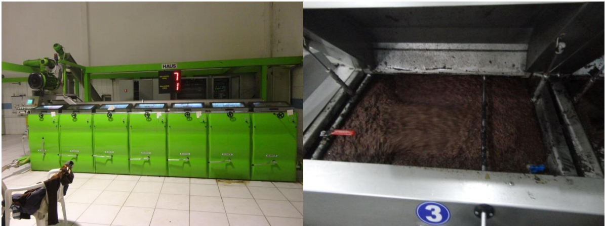
Şekil 50. Zeytin hamurunun olgunlaştığı malakasyon ünitesi
