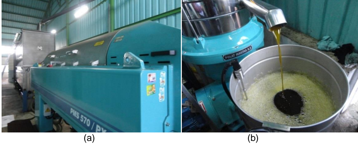
Şekil 36 Pirina tesisinde uygulanan 2. sıkım işlemi, a) 2. sıkım yapan dekantör b) 2. sıkım sonrası oluşan pirina yağı
