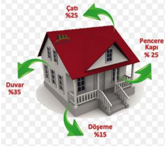
Şekil 12 - Binalardaki ısı kaybının ana kaynakları
