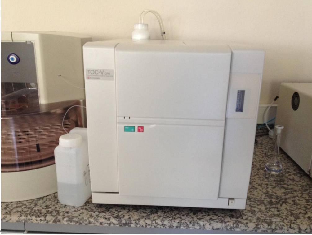
Şekil 2.2. Toplam Organik Karbon Analizörü (DEÜ ÇEVRE MÜH. LAB.)
