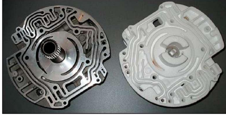
Şekil 2.37: Yitik Köpük Prosesi İçin Genleşen Polistiren Modeli (sağda) ve Yitik Kalıp Metodu ile Üretilen Bir Döküm Örneği (solda) [237, HUT, 2003]
