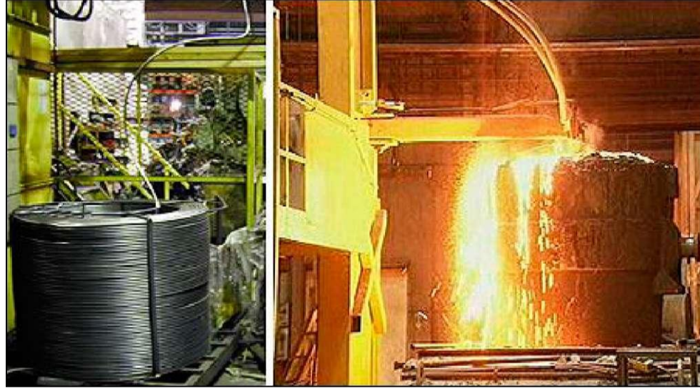
Şekil 2.22: Alüminyum tel kullanılarak gerçekleştirilen deoksidasyon [237, HUT, 2003]
