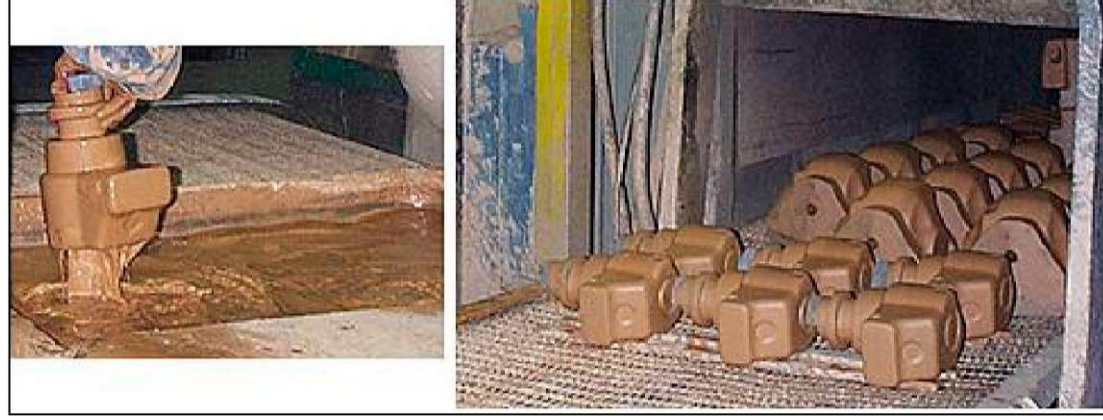
Şekil 2.35: Su Bazlı Kaplama Malzemeleri İle Daldırma Kaplama ve Akabinde Sıcak Hava Fırınında Kurutma İşlemi [237, HUT, 2003]
