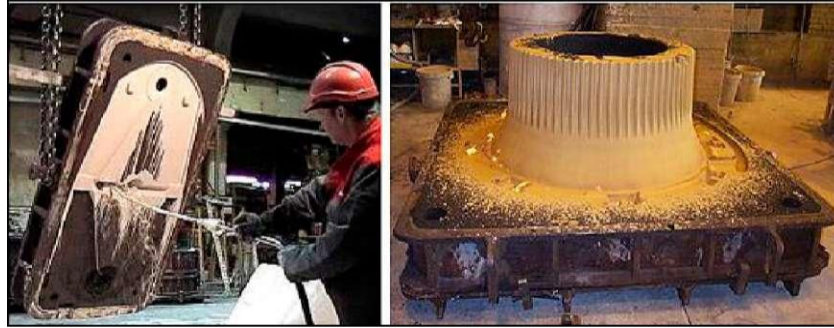
Şekil 2.34: Alkol bazlı kaplamalarda akıtmalı kaplama ve akabinde ateşleme ve kurutma [237, HUT, 2003] Su bazlı kaplamaların kurutulması sıcak hava, kızılötesi ya da mikro dalgalar kullanılarak kurutma fırınında ısıtma yoluyla gerçekleştirilir. Maçaların daldırılarak bitirilmesi ve sonrasında uygulanan sıcak hava kurutması Şekil 2.35'te gösterilmiştir. Su bazlı kaplamalar kaplama ya da kurutma esnasında emisyon problemleri meydana getirmez. Bu nedenlerden dolayı, su bazlı kaplamalar giderek alkol bazlı kaplamaların yerini almaktadır.
