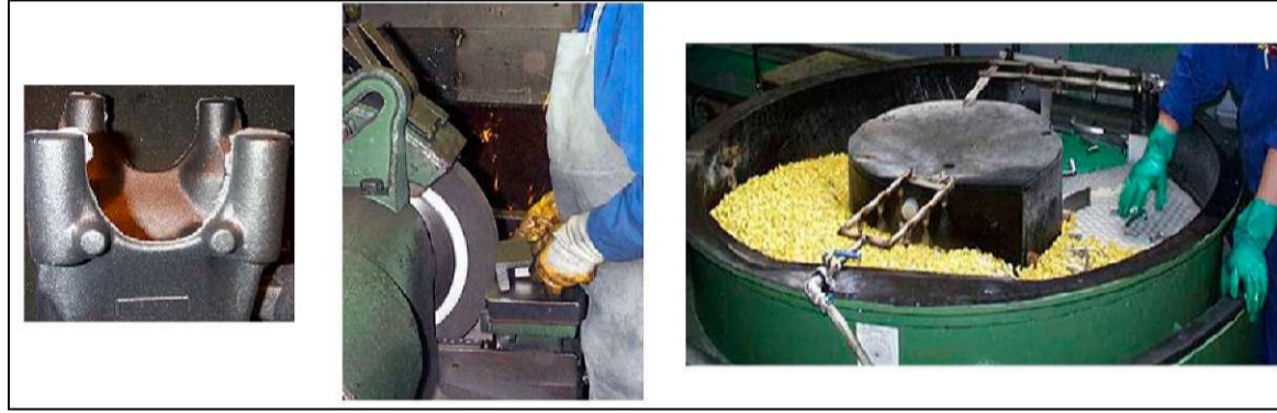
Şekil 2.51: Çapak (solda) ve BilemeTaşı (ortada) ve Sürge Taşlama İşlemi (sağda) Kullanarak Çapağın Kaldırılması [237, HUT, 2003]
