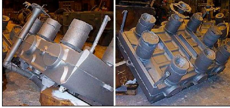
Şekil 2.49: Çalıştırma ve kaplama sisteminin dökümü[237, HUT, 2003]
