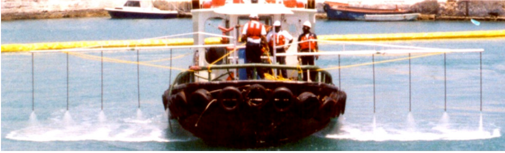
Şekil 6.2: Bir dispersant püskürtme botu
