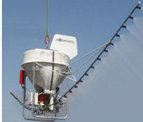
Şekil 6.9: Simplex 6810 püskürtme kovası
