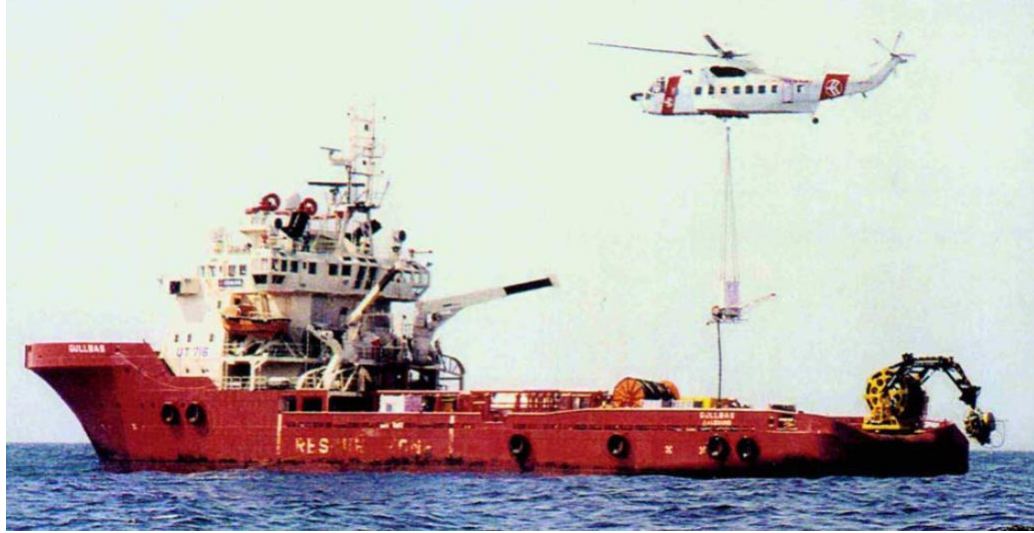
Şekil 6.10: Sikorski 61N helikopteri RESPONSE 3000 dispersant püskürtme kovanını destek gemisinden doldururken
