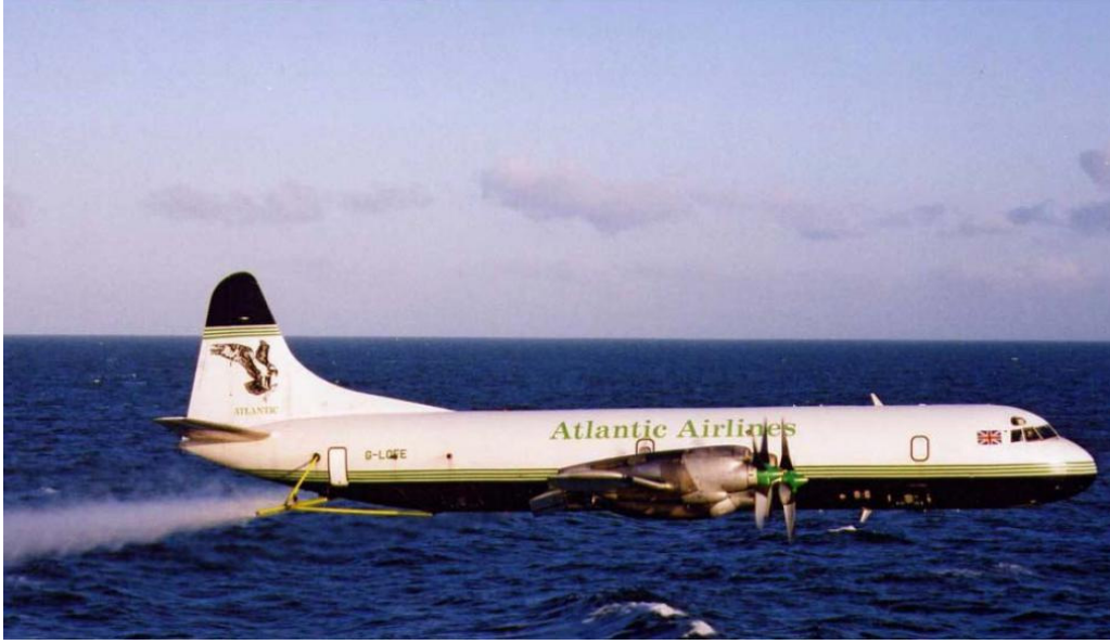
Şekil 6.6 : Lockheed Electra uçağı dispersant püskürtürken
