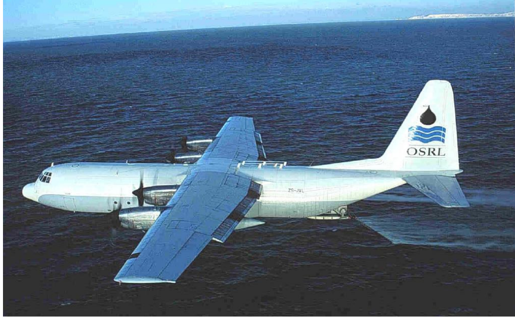
Şekil 6.7 ADDS paketli Lockheed L-382 Hercules uçağı
