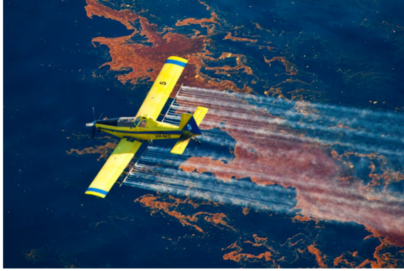
Şekil 6.5 : Air Tractor AT-602 zirai ilaçlama uçağı dispersant püskürtürken
