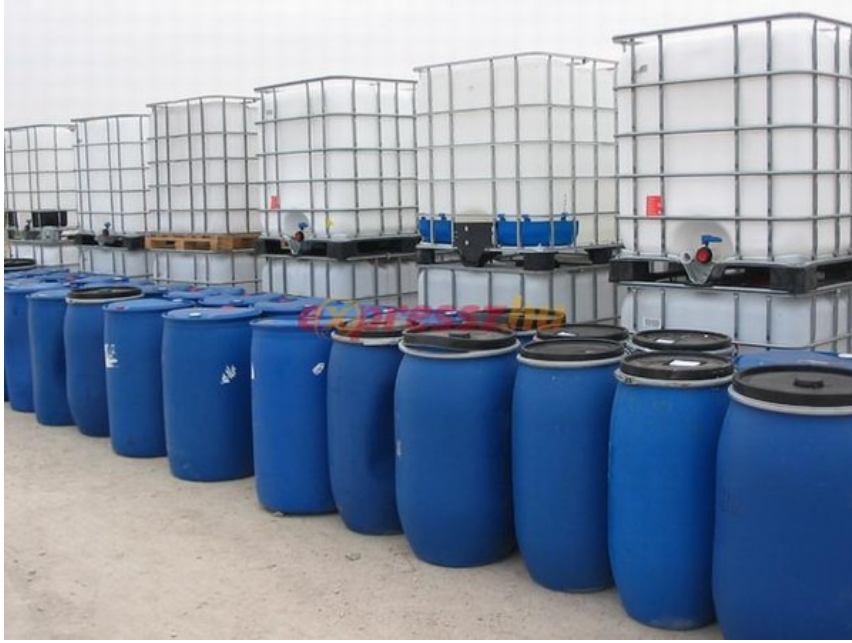
Şekil 6.1: Dispersantların uygun saklanma şekilleri olan varil ve IBC konteynerler
