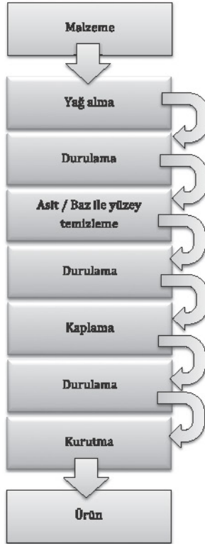
Şekil 1 Metal kaplama prosesi akım şeması
