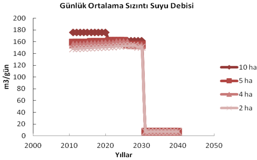
Şekil 5-7 Depolama alanı işletim süresi ve kapanmayı izleyen 10 yıllık devrede sızıntı suyu oluşumu (Malatya)
