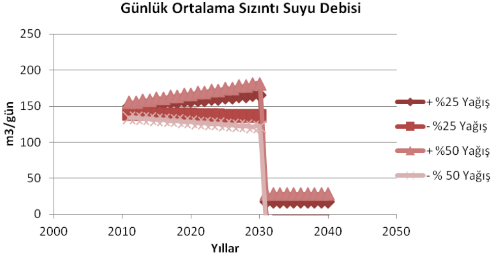
Şekil 5-19 Depolama alanı işletim süresi ve kapanmayı izleyen 10 yıllık devrede sızıntı suyu oluşumu (Malatya)
