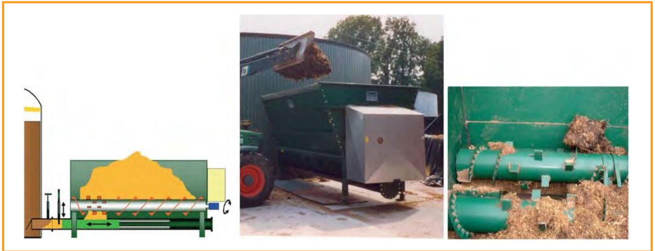
Şekil 3.18: İstiflenebilir biyokütlenin aktarma pistonuyla yüklenmesi [PlanET Biogastechnik GmbH]
