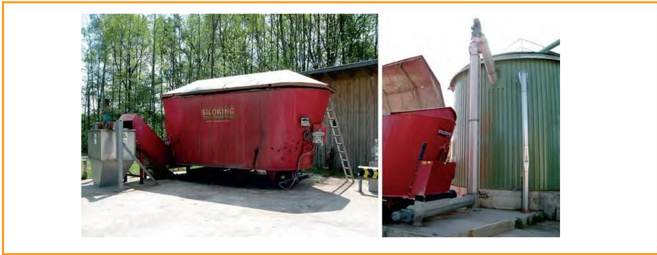
Şekil 3.19: İstiflenebilir biyokütlelerin besleme helezonlarıyla yüklenmesi [DBFZ]
