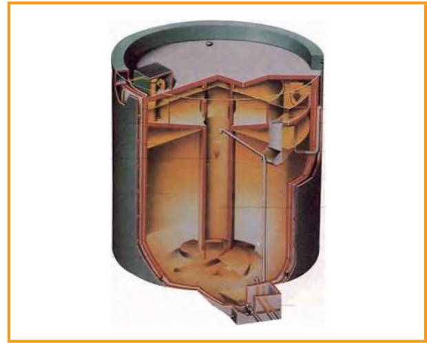
Şekil 3.27: Çift bölmeli fermentör [ENTEC Environment Technology Umwelttechnik GmbH]
