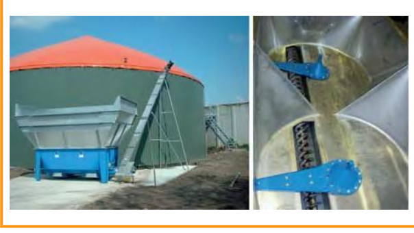
Şekil 3.6: Parçalama tertibatlı bir yükleme düzeneği [Konrad Pumpe GmbH]
