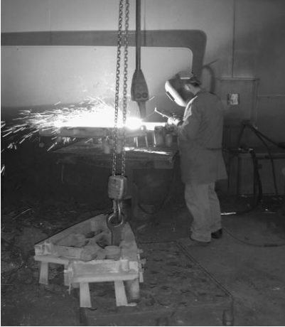
Resim 3.5: Döküm sonrası temizlik Kaynak:Oederlin Döküm i AG, Rieden b. Nussbaumen, İsviçre
